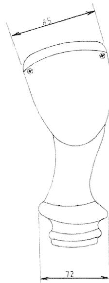
*1, 2, 3, ..., 10 fonctions peuvent être commandées entre le pouce et l'index, sans fatigue grâce à une garde d'appui de la main*
